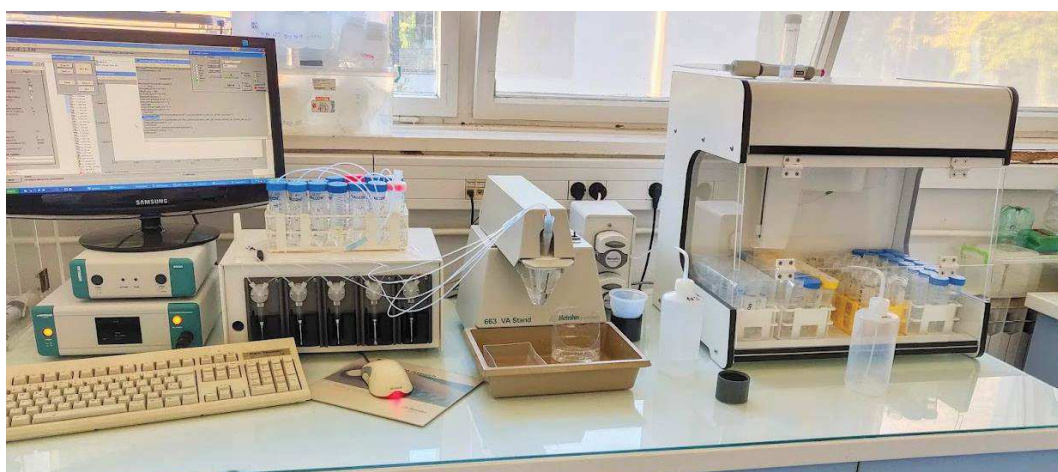
Slika 2. Automatizirani voltametrijski sustav za određivanje koncentracija Zn, Cd, Pb, Cu i Ni u vodi.
